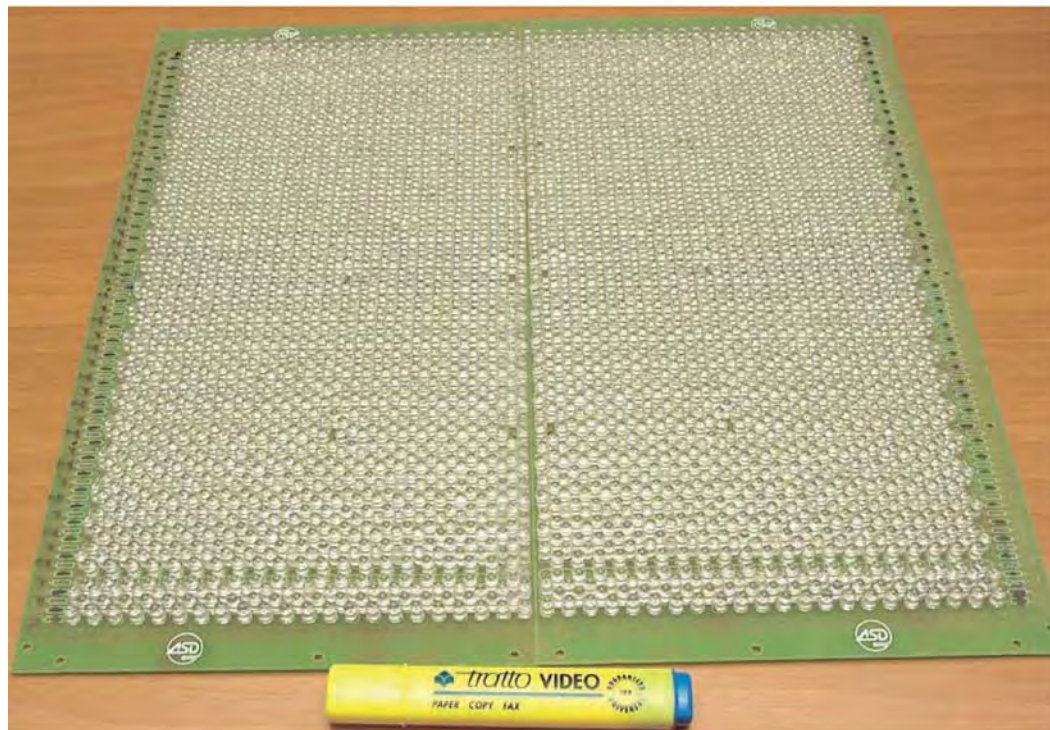
Figura 3 - Sistema di illuminazione a pannelli di LEDs rosso/blu (92%/8%). PAR: 800 \mu\text{mol m}^{-2} \text{s}^{-1}
