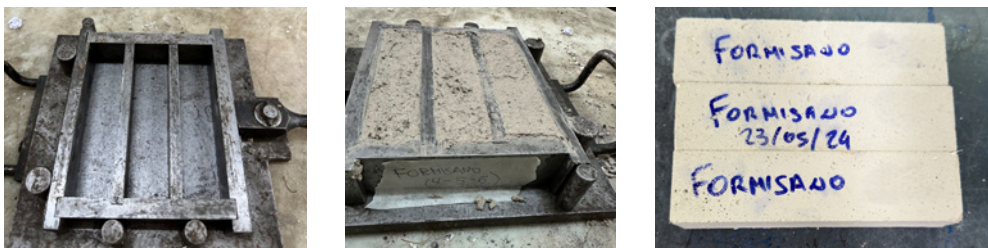
Figura 5. Confezionamento dei provini 40 \times 40 \times 160 mm.
