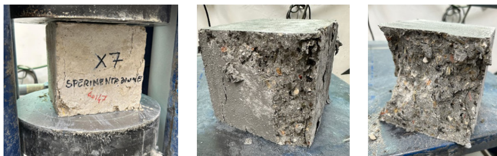
Figura 13. Malte per massetti/blocchi: provini al termine della prova di rottura a compressione.
