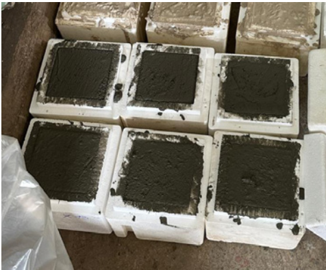
Figura 11. Provini cubici 150 × 150 × 150 mm utilizzati per le prove di compressione sulle malte per massetti e blocchi.
